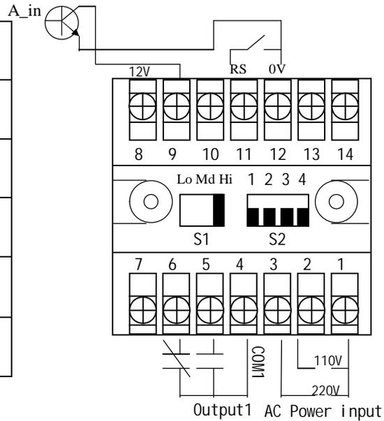
信号输入方式 Signal Input Type
